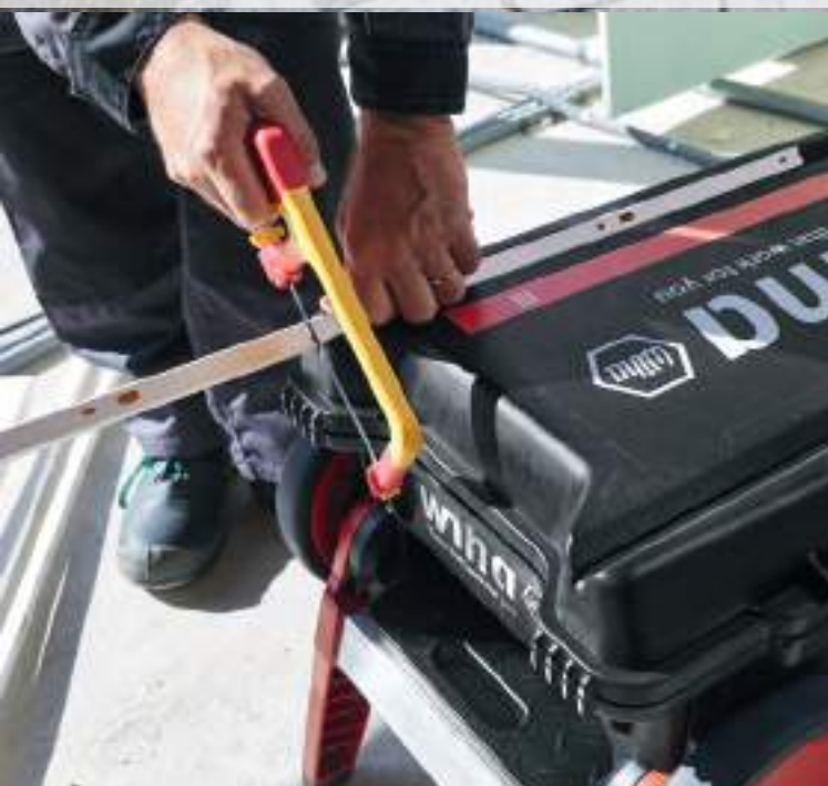
V-vormige inkeping met schaal in het kofferdeksel
